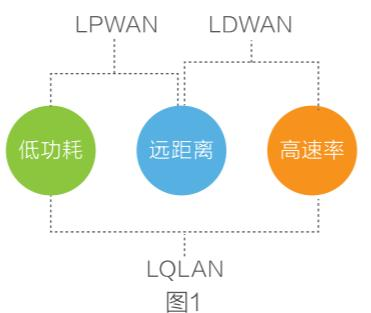
如图1所示，满足远距离和高速率的LDWAN (Large amount of Data Wide Area Network) 发展最为成熟，目前3G、4G、5G等移动运营网络技术均属于LDWAN的物联网无线通讯领域；满足远距离和低功耗的LPWAN (Low Power Wide Area Network) 发展最为迅速，近年来出现的LoRaWAN、NB-IoT、Sigfox、eMTC等技术很好地推动了LPWAN的发展。还有一种能够同时满足低功耗和高速率的LQLAN (Low power and Quick response Local Area Network) 需求也正在迅速升温，我司近期
