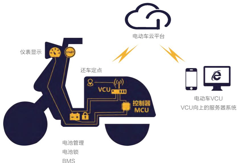
VCU模块内部集成了GPS、GPRS/NB-IoT、陀螺仪等模块, 用户可以通过手机远程查询当前车身状态以及位置信息。当车身出现碰撞、翻倒、超出电子围栏等情况时, 能够给APP或客户端推送信息, 提示车主车身异常情况, 并可通过手机远程断电、锁定电机。模块内含锂电池, 在外部断电情况下, 确保VCU还能正常工作24小时。
