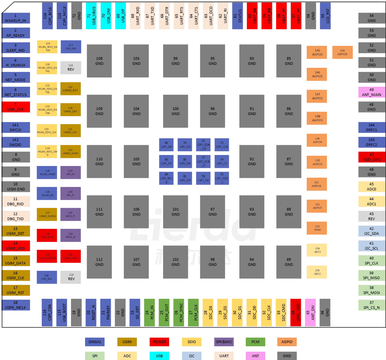
图 2.2 模组引脚分配图
