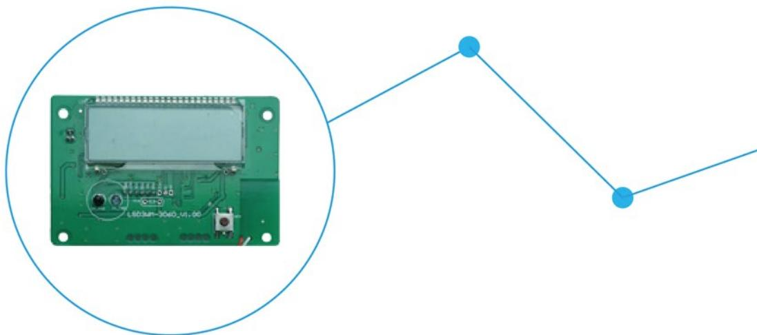
超声波水表控制器是基于超声波原理进行流量传感的，用于测量和显示用水量的仪表的电子部分。超声波水表控制器是依照国家GB/T 778-2007《饮用冷水水表和热水水表》标准，兼容CJ/T 188-2004《户用计量仪表数据传输技术条件》开发设计的高性能、低功耗电子式水表模块。超声波水表控制器由超声波流量处理单元和微处理器控制单元组成。流量计量采用超声波技术完成，依据标准流量计算公式计算出管道流经的水量。超声波水表控制器还可通过LCD屏显示系统被测量相关参数,如累计流量 (m<sup>3</sup>)、累积运行时间、流速 (m<sup>3</sup>/h)、当前日期、18 个月历史数据、版本号等，并具备自动错误诊断功能，确保设备稳定、准确运行。
