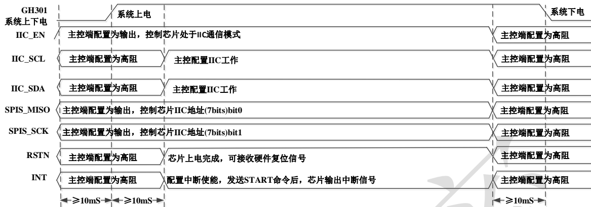
图 6 IIC 系统控制时序图
