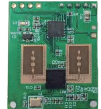
斯凯瑞利 77G 毫米波雷达可穿透光照、降雨、扬尘、雾或霜探测物体，是一种全天候、全天时工作的小型传感器，具有集成度高、体积小、接口灵活等优点，可以检测静止的活体，能测距、测角、测速、追踪人数，可应用于卫浴、自动感应门、安防电子围栏、道闸、门禁、车用 BSD、车内活体检测、能耗管理、行驶记录仪用触发雷达、智能家居、养老院、地磁、智能路灯等场合，能良好解决传统传感器的误触问题。
